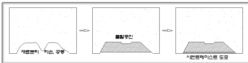
〈그림 8.4〉 단면보수(철근비노출부) 공법 개요도
